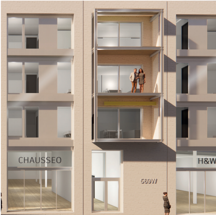
BALCON MÉTALLIQUE RAPPORTE : Structure métallique avec finition «métallisée chaud», garde corps en verre
