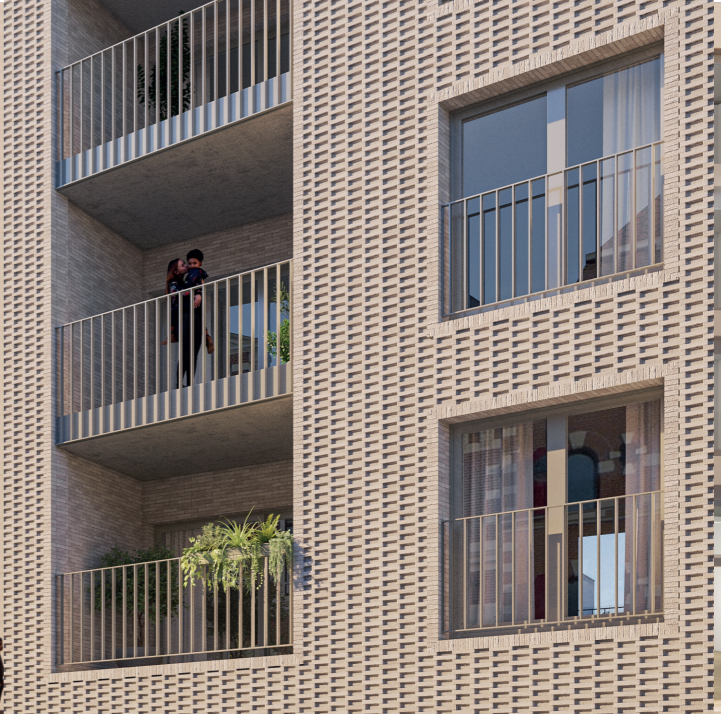
MENUISERIES ET SERRURERIES MÉTALLIQUES Menuiserie en aluminium «métallisé chaud» Garde corps : barreaudage métallique finition idem menuiseries
