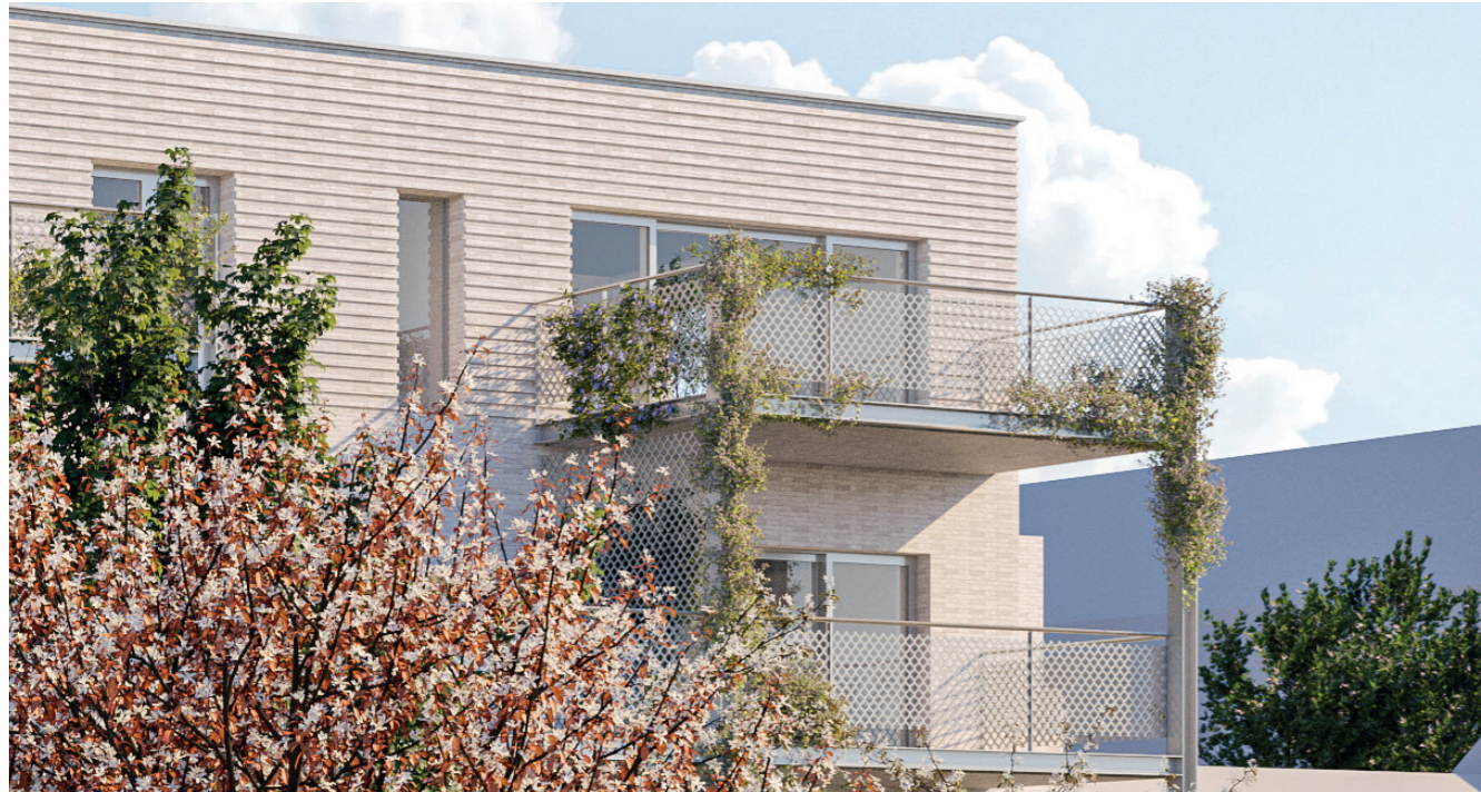
BALCON MÉTALLIQUE RAPPORTE : Structure métallique avec garde corps en maille métallique et végétalisation.
