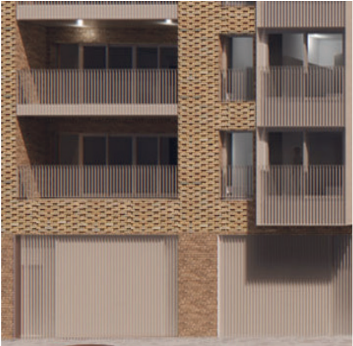
UNE COHÉRENCE DU REZ-DE-CHAUSSEE : Porte de garage basculante, habillage tôle métallique et barreaudage, finition «métallisé chaud»
